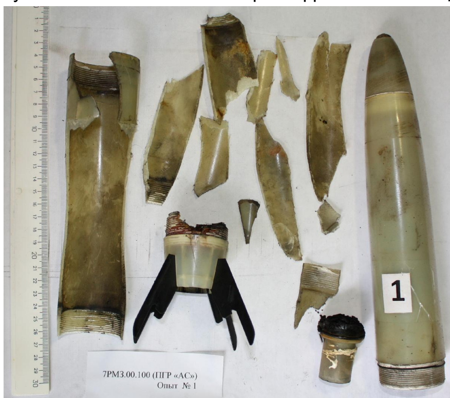
Рисунок 3 – Фрагменты дробления корпуса ПГИ «Ас»
